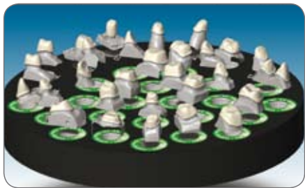
Scansione e modellazione automatica di 30 elementi
