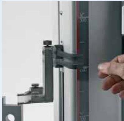
Ill. 2. Il motore parte e la procedura di misurazione sarà completata automaticamente
