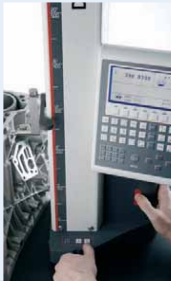
Ill. 2. Il motore parte e la procedura di misurazione sarà completata automaticamente
