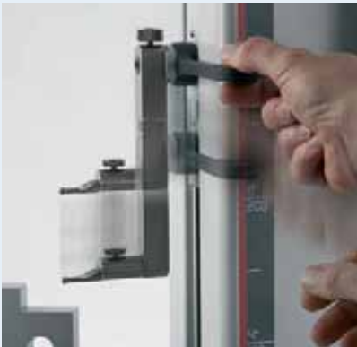
Ill. 1. Muovere il carrello di misura manualmente in direzione del pezzo da misurare.
